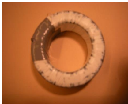
1:4: bifilar 10..12 Wdg PE-isol.Schaltdraht rt/sw/verdr.=Masse, bei rt. und sw. 200Ohm bei sw. 50Ohm unsymm. zum TX
