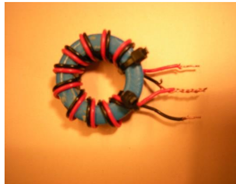
1:4: bifilar 10..12 Wdg PE-isol.Schaltdraht rt/sw/verdr.=Masse, bei rt. und sw. 200Ohm bei sw. 50Ohm unsymm. zum TX
